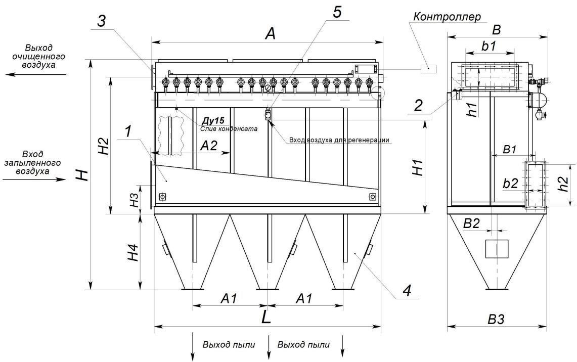
**Рис.3 Схема фильтров рукавных типа ФРИП-90; ФРИП-540.**
