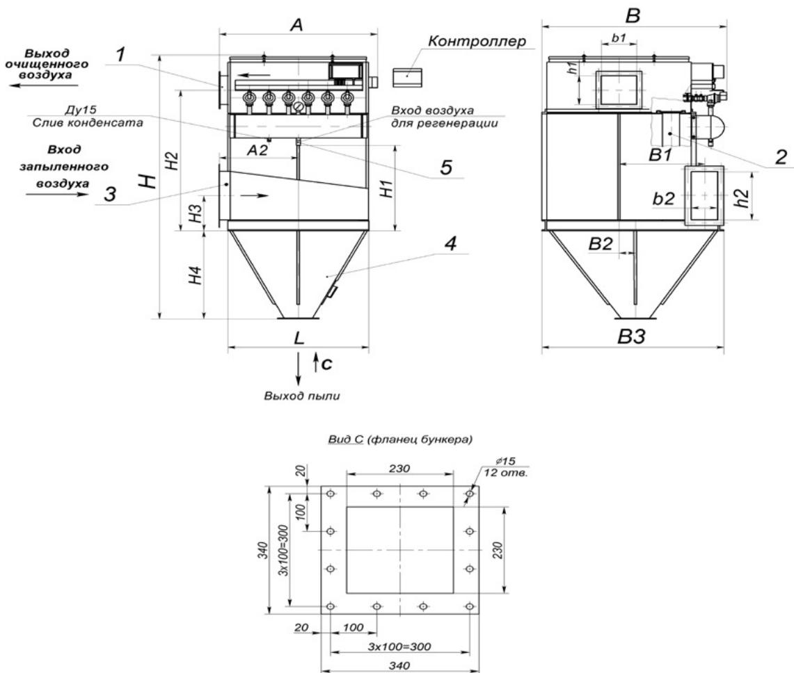
**Рис.1 Схема фильтров рукавных типа ФРИП-5; ФРИП-10; ФРИП-15; ФРИП-30; ФРИП-180.**
