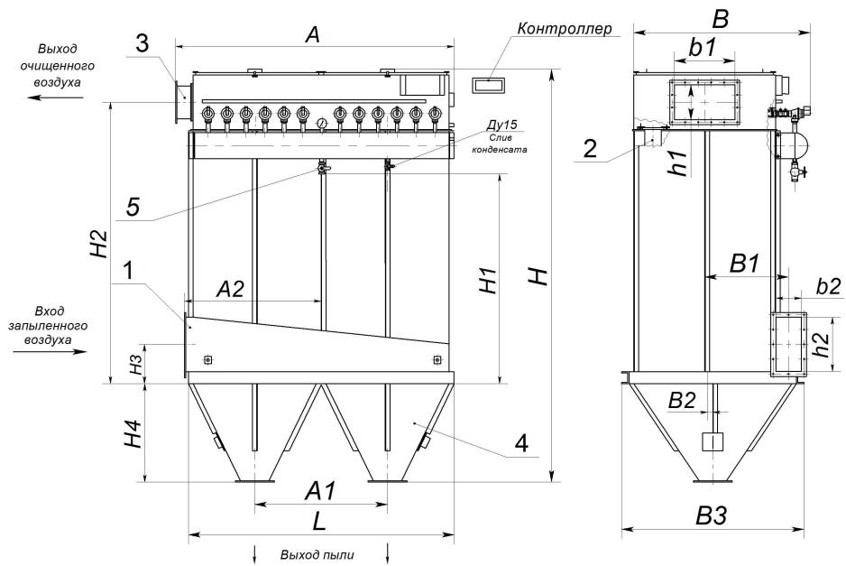
**Рис.2 Схема фильтров рукавных типа ФРИП-60; ФРИП-270; ФРИП-360.**
