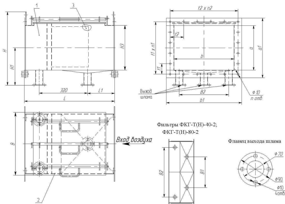
**Рис. 2 Схема фильтров ФКГ-Т(Н)-2**
