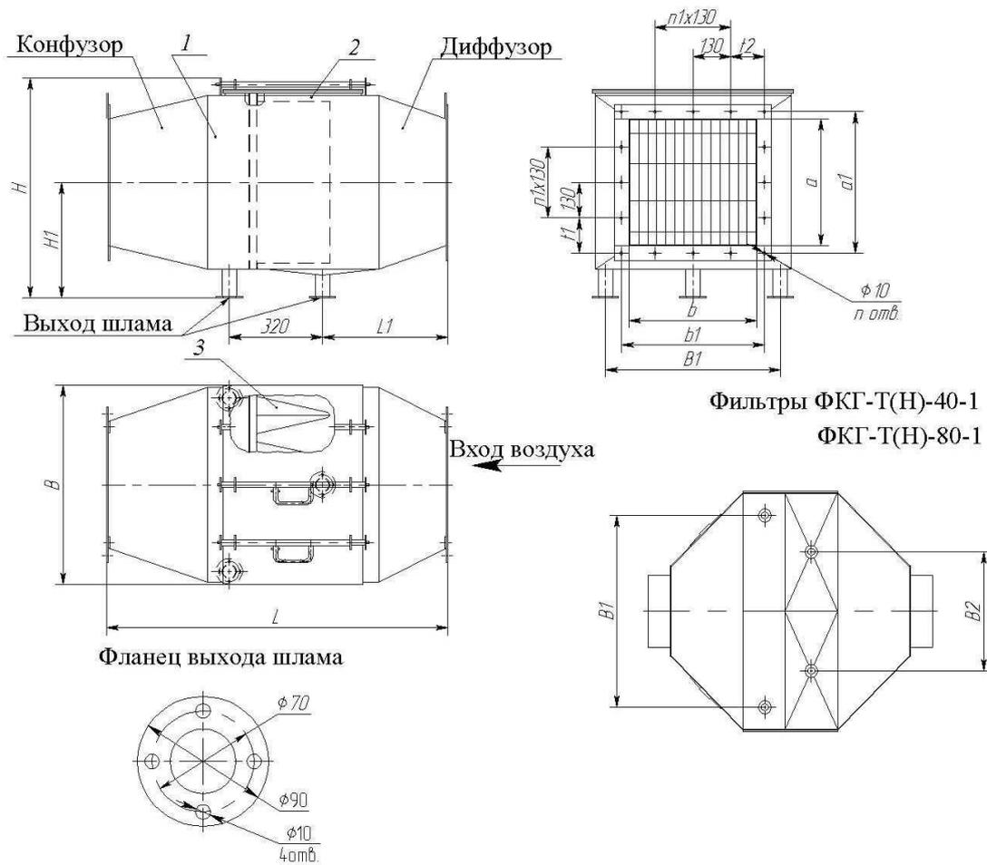
Рис. 1 Схема фильтров ФКГ-Т(Н)-1
