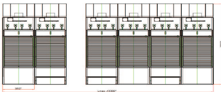
Рис. 4 Объединение камер КФВ-ОИ (ОИ) в единую секцию внутри производственных помещений
