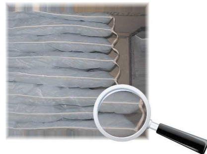
Рис. 3 Фото во время испытаний карманного фильтра с постоянным зазором между карманами
