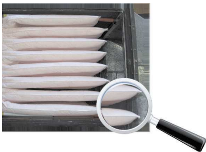
Рис. 2 Фото во время испытаний карманного фильтра с карманами клиновидной формы
